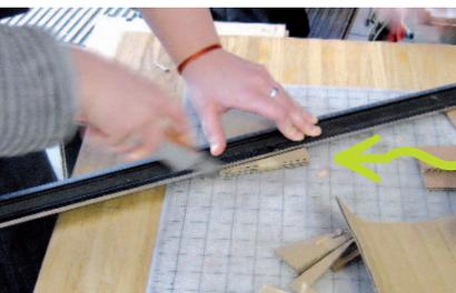
Pour la découpe, on scotche les différentes épaisseurs ensemble avec du papier gommé de façon à avoir des mesures parfaitement identiques. On peut travailler au cutter ou à la scie sauteuse avec une petite lame à métal.
