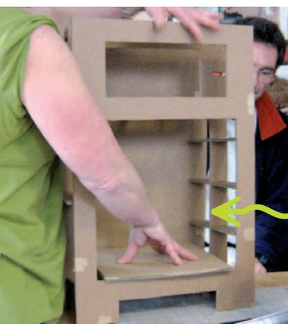
On trace des repères au niveau de l'emplacement des encoches sur les façades de devant et de derrière, de façon à coller les montants au bon endroit et bien droits.
